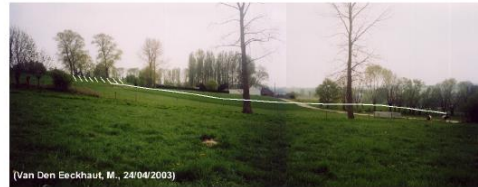
Foto 1B: Zicht op GV. 107 met aanduiding van de hoofdsteilrand (verticale lijnen) en de accumulatiezone (horizontale lijn)
